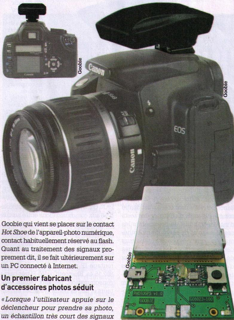
Goobie qui vient se placer sur le contact *Hot Shoe* de l'appareil-photo numérique, contact habituellement réservé au flash. Quant au traitement des signaux proprement dit, il se fait ultérieurement sur un PC connecté à Internet.
